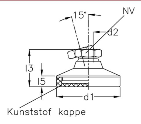
d1 = 32 d2 = 10 l3 = l5 = -NV = 15 Static load (N) = 11 t min = 10.5
